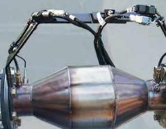
9. Sistema CONVERTIDOR CATALITICO Incluye sensores UE60 y RTD ideal para cumplir requerimientos de baja emisión
