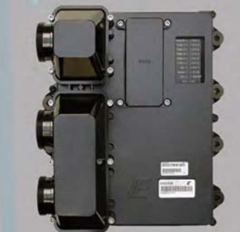
3. Unidad de Control del Motor ECU Sistema de computadora integrado, controla funciones vitales del motor
